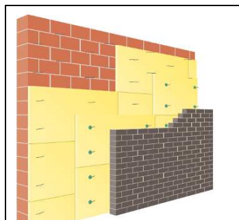
Figure 35 : Exemple de mur creux (source : Isover)
